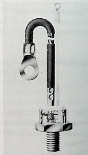
fig. 1.2 Het inwendige van een tweetal thyristoren
