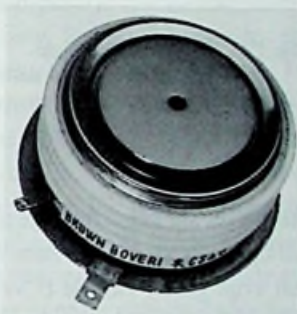
fig. 1.3c Behuizingen van vermogenshalfgeleiders Groot vermogen (effectieve stroom tot enkele honderden ampères)
